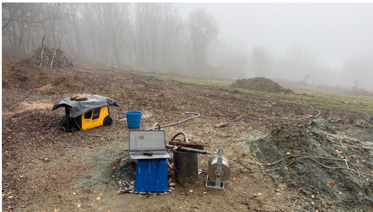
Obrázek 16: Čerpací zkouška na vrtu HEV-1
